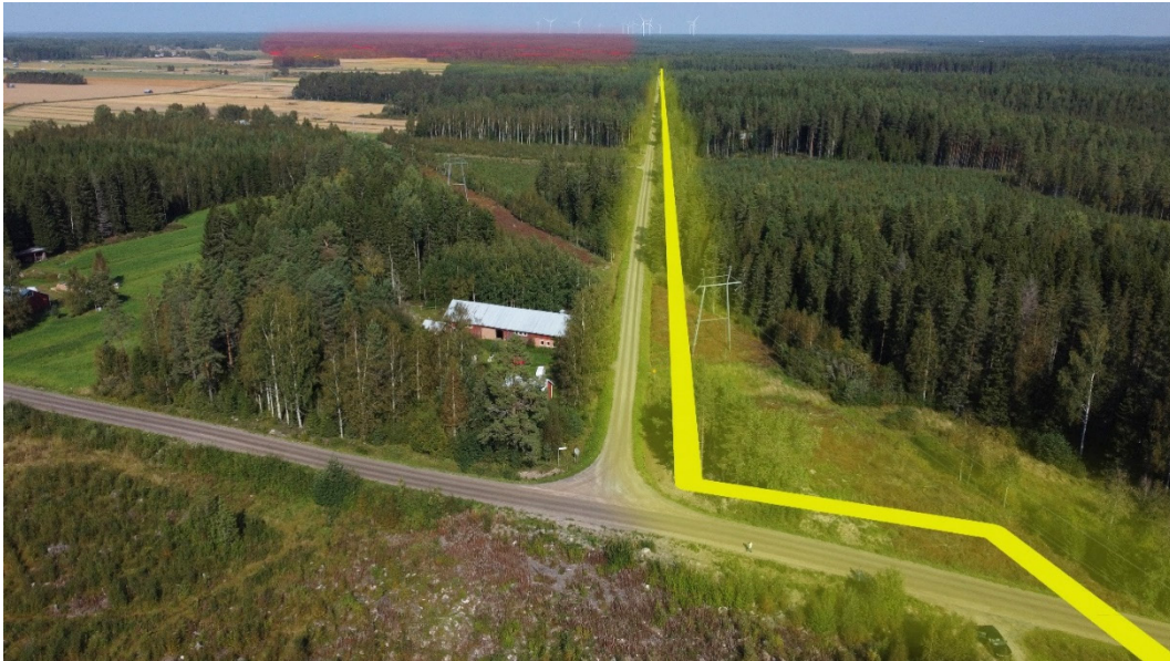
Kuva 36. Näkymä Brännskogintien varrelta lounaasta koilliseen. Maakaapeli rakennetaan tiealueelle, periaate näytetään keltaisella viivalla. Kaavoitusalue näytetään punaisella.
